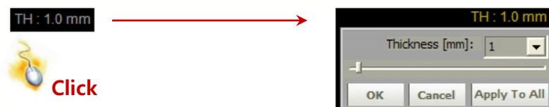
Configure el grosor deseado por el usuario ajustando el valor de Grosor (0~30mm). Después de configurar este valor, se ajustará el grosor de MPR de eje aplicable.
