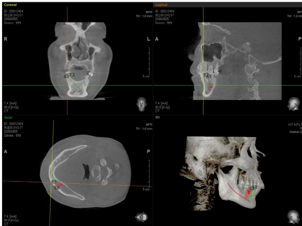
Pero cuando se detecte la colisión entre Canal e Implante, la Zona de seguridad en verde se pone en rojo mostrando el mensaje **“Collisions are detected”** (Se han detectado colisiones).
